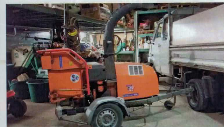
Ce broyeur Tünnissen produit des plaquettes de calibre standard (20-30 mm) pour alimenter la chaudière.
