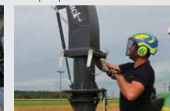
Goulotte orientable à 360° manuellement et casquette d'éjection réglable.
