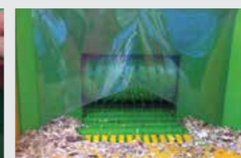
Système d'alimentation puissant rouleau et tapis ameneur en acier à dents d'entraînement soudées
