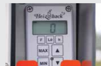
Système de commande no-stress Heizohack HE 002 pour régler l'avancée du bois à déchiqeter en fonction de la puissance d'entraînement.
