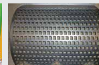
Grilles de calibrage interchangeables selon la taille de plaquettes souhaitée.
