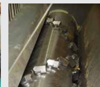
Rotor lent à dents en carbure de tungstène
