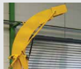
Tourelle orientable à 380° et casquette d'éjection réglable.
