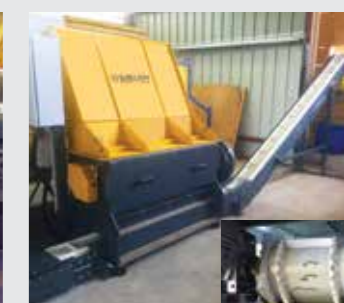
Tapis de convoyage avec rouleau magnétique pour l'extraction des clous (en option)
