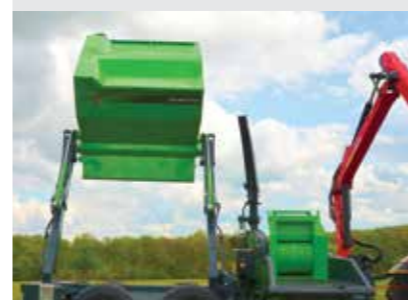
Benne à vidage par le haut s'élevant jusqu'à 4 m
