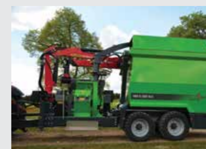
Montage compact sur châssis tandem
