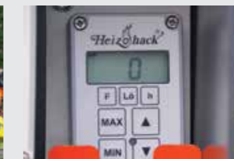
Système de commande no-stress Heizohack HE 002 pour réguler l'avancée du bois à déchiqueter en fonction de la puissance d'entraînement.
