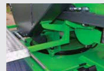
Plateau tournant à 270° pour orienter le broyeur selon le chantier.
