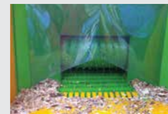
Système d'alimentation puissant à vitesse réglable. (rouleau et tapis ameneur en acier à dents d'entraînement soudées).
