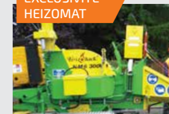
Soufflerie à volant d'inertie : bonne éjection des plaquettes . réserve de puissance.
